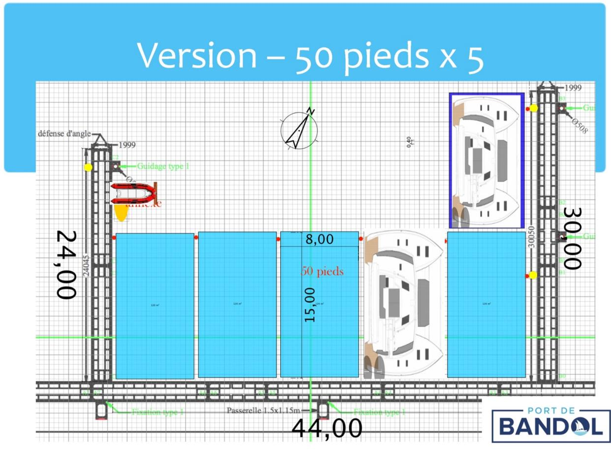
Ce plan de mouillage est un exemple de ce qu'il est possible de faire dans la zone de l'AOT. Le candidat pourra proposer un autre plan de mouillage en fonction du nombre et de la dimension des catamarans souhaités.
