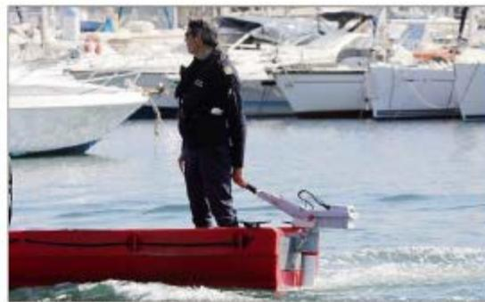
Les équipes du port peuvent compter aussi sur une nouvelle barque en plastique rotomoulé équipée d'un moteur électrique doté d'une journée d'autonomie.
